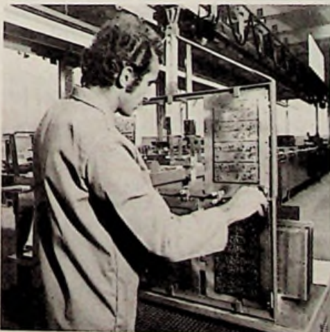
Bedradingskaarten worden uit een produktieraam genomen
